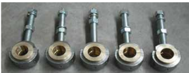
Diferentes soportes intermedios (péndulos) con casquillos de bronce, deirin, etc. con sus ejes intermedios.
