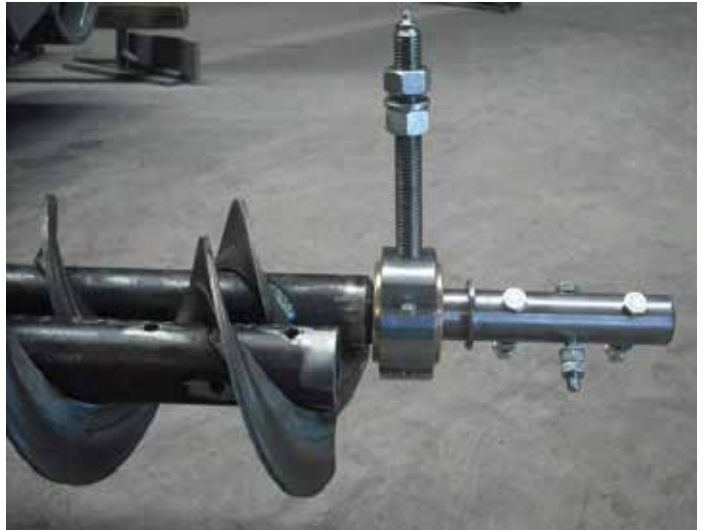
Diferentes soportes intermedios (péndulos) con casquillos de bronce, deirin, etc. con sus ejes intermedios.
